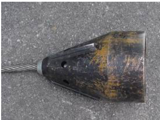
Der Seilberster X 300 C mit gebogener Frontplatte wird im Ø 800 mm Schacht installiert.
